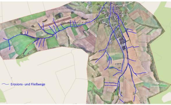
Abbildung 4: Auswertung der Erosions- und Fließwege auf der Grundlage der Drohnenbefliegung des Kreises (erstellt durch die Stadt Brakel)
