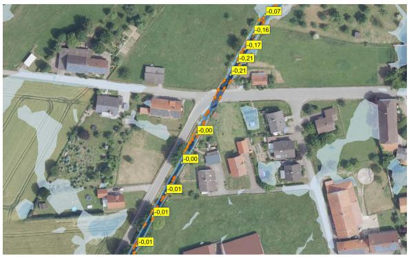
Abbildung 32: Wasserspiegeldifferenz Planungszustand minus Istzustand, Aufweitung Wassergraben Szenario 1
